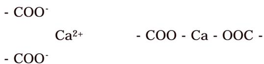
一方、イオン交換は、対象物質のある部分にもともと2つの  $\text{Na}^+$  を保有しており、その  $\text{Na}^+$  を放出する代わりに  $\text{Ca}^{2+}$  や  $\text{Mg}^{2+}$  を捕捉します。 $\text{Ca}^{2+}$  や  $\text{Mg}^{2+}$  は洗淨に悪影響を及ぼしますが、 $\text{Na}^+$  はかえって洗淨に有利に働きます。なお、純水製造装置
